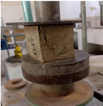
Figura 2. Proceso de compresión de adobes
